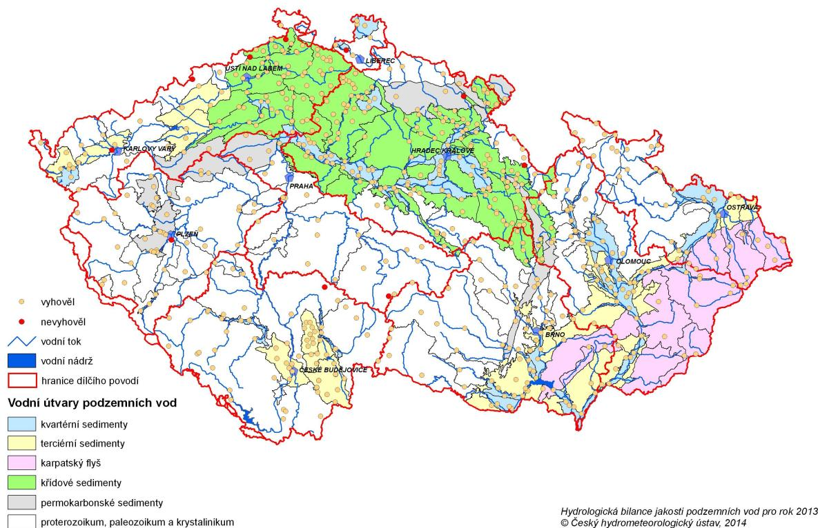
Hodnocení jakosti podzemních vod – porovnání s referenční hodnotou pro podzemní vodu v ukazateli kadmium (0.5 µg/l) dle vyhlášky MŽP a MZe č. 5/2011 Sb. - dílčí povodí Dolní Vltavy
