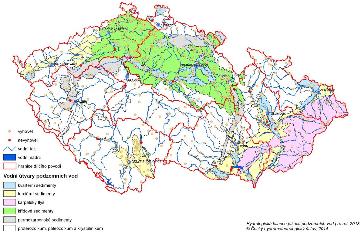
Hodnocení jakosti podzemních vod – porovnání s referenční hodnotou pro podzemní vodu v ukazateli chloridy (200 mg/l) dle vyhlášky MŽP a MZe č. 5/2011 Sb. - dílčí povodí Dolní Vltavy
