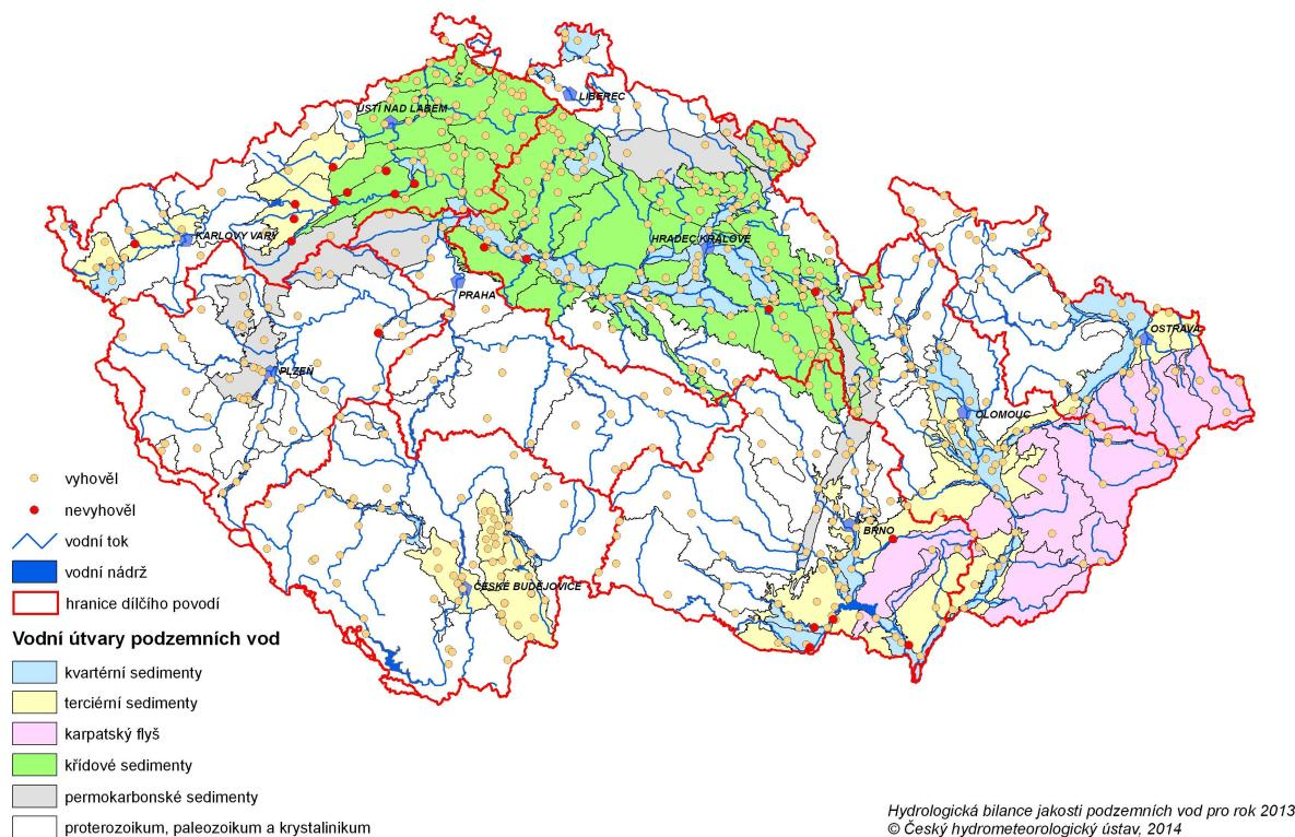
Hodnocení jakosti podzemních vod – porovnání s referenční hodnotou pro podzemní vodu v ukazateli sírany (400 mg/l) dle vyhlášky MŽP a MZe č. 5/2011 Sb. - dílčí povodí Dolní Vltavy
