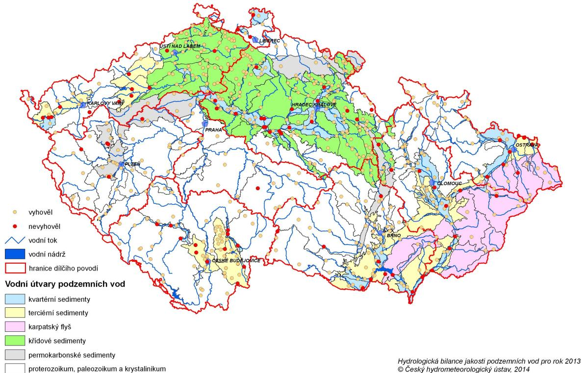
Hodnocení jakosti podzemních vod – porovnání s referenční hodnotou pro podzemní vodu v ukazateli ChSK-Mn (3 mg/l) dle vyhlášky MŽP a MZe č. 5/2011 Sb. - dílčí povodí Dolní Vltavy
