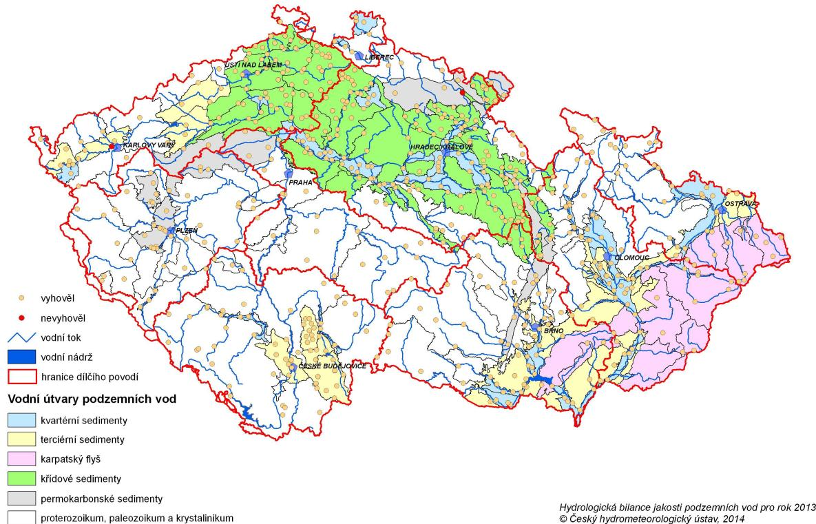
Hodnocení jakosti podzemních vod – porovnání s referenční hodnotou pro podzemní vodu v ukazateli olovo (5 µg/l) dle vyhlášky MŽP a MZe č. 5/2011 Sb. - dílčí povodí Dolní Vltavy
