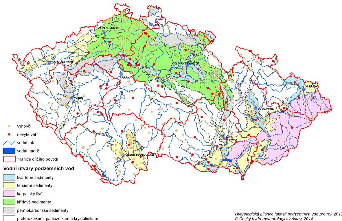
Hodnocení jakosti podzemních vod – porovnání s referenční hodnotou pro podzemní vodu v ukazateli dusičnany (50 mg/l) dle vyhlášky MŽP a MZe č. 5/2011 Sb. - dílčí povodí Dolní Vltavy
