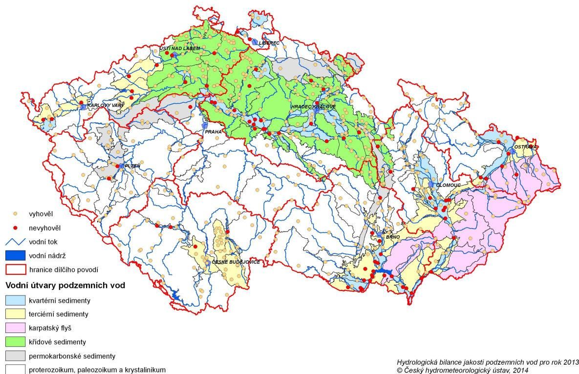
Hodnocení jakosti podzemních vod – porovnání s referenční hodnotou pro podzemní vodu v ukazateli amonné ionty (0.5 mg/l) dle vyhlášky MŽP a MZe č. 5/2011 Sb. - dílčí povodí Dolní Vltavy
