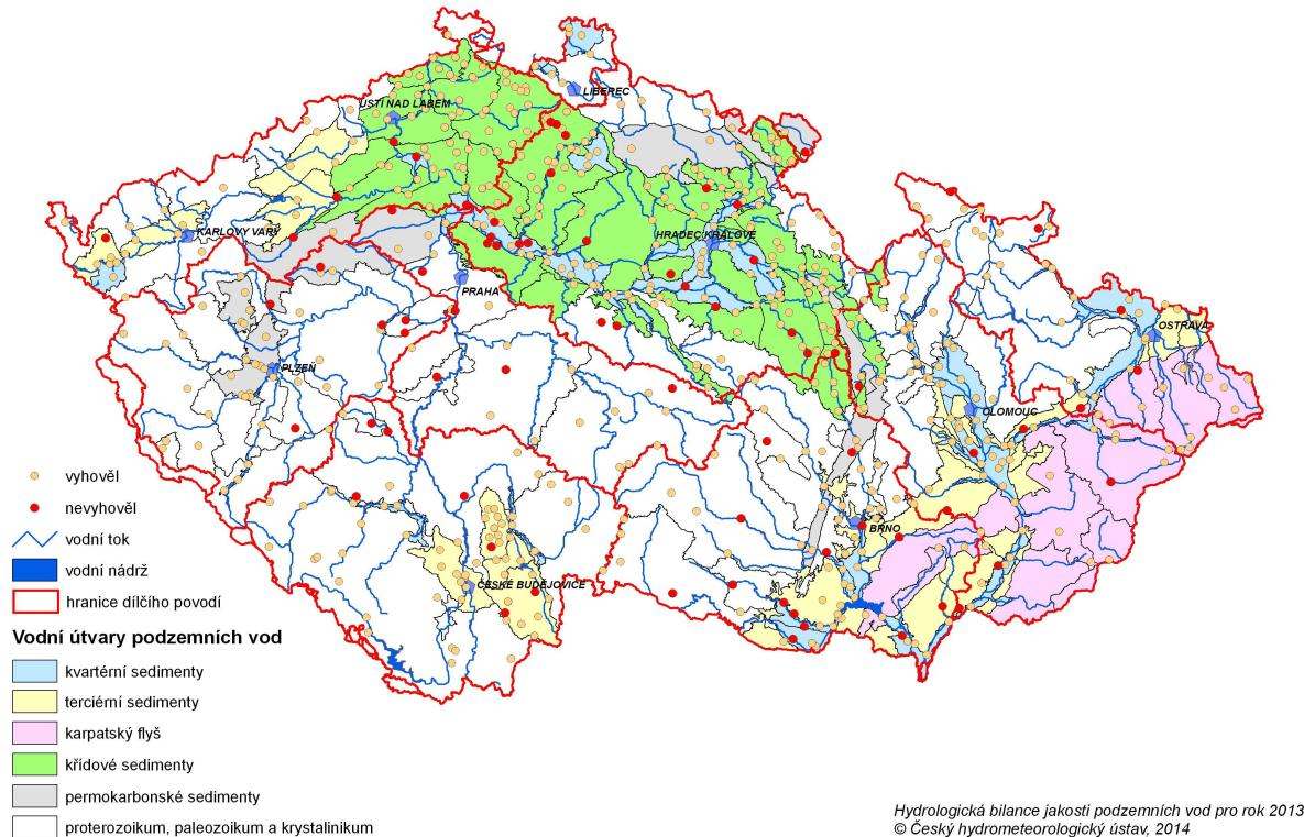
Hodnocení jakosti podzemních vod – porovnání s referenční hodnotou pro podzemní vodu v ukazateli dusičnany (50 mg/l) dle vyhlášky MŽP a MZe č. 5/2011 Sb. - dílčí povodí Berounky
