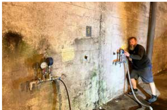
Měření vztlakomerných vrtů v hrázi VD Orlik
