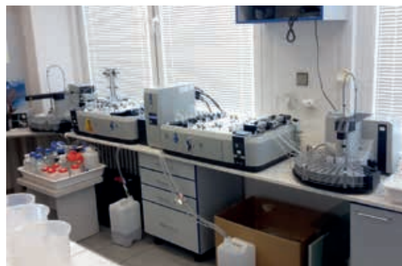
NOVĚ INSTALOVANÝ PRŮTOKOVÝ ANALYZÁTOR ZÁKLADNÍCH CHEMICKÝCH IONTŮ
