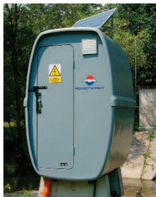
Automatická vzorkovací stanice na Sedlickém potoce v povodí VN Švihov, používaná k odběru vzorků pesticidů a živin
