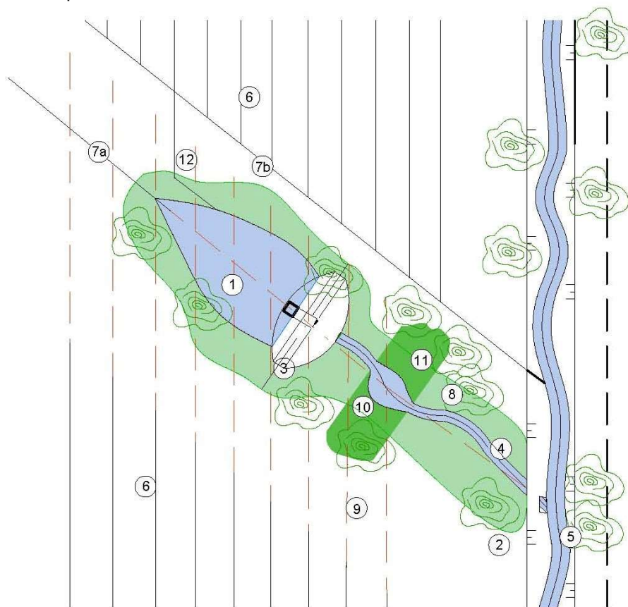
1 - tůň; 2 - doprovodná vegetace; 3 - zemní val z výkopku; 4 - odtok z tůně; 5 - recipient; 6 - sběrné drény; 7a - svodný drén; 7b - svodný a zasakovací drén; 8 - zatravnění; 9 - eliminované drenážní potrubí; 10 - rozšíření vodního toku; 11 - zatravněný pás s podporou infiltrace; 12 - napojení drenážního odtoku do tůně
