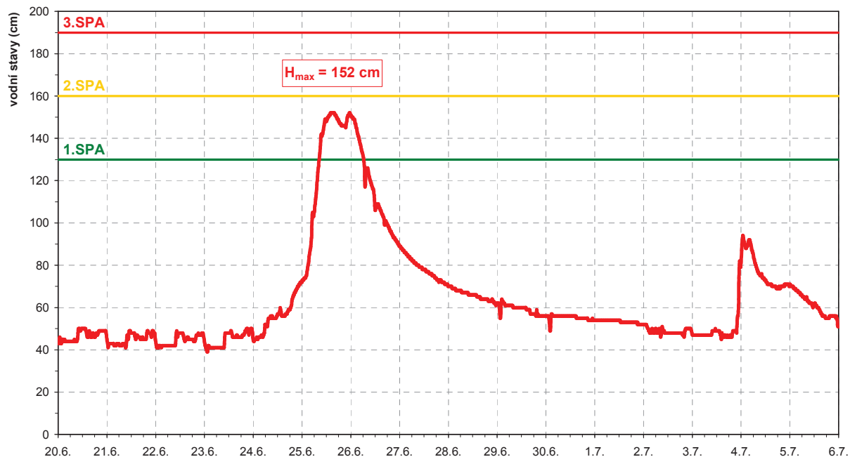
Malše - Pořešín (vodní stavy) - povodeň červen 2013 - II. vlna
