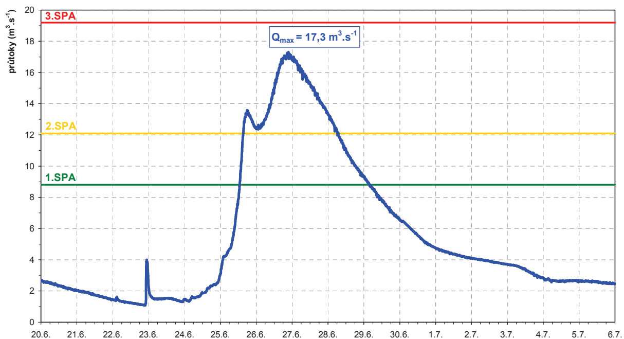
Stropnice - Borovany (průtoky) - povodeň červen 2013 - II. vlna
