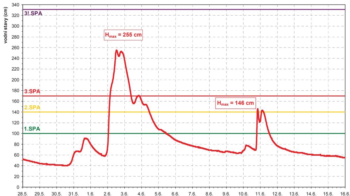
Černá - Ličov (vodní stavy) - povodeň červen 2013
