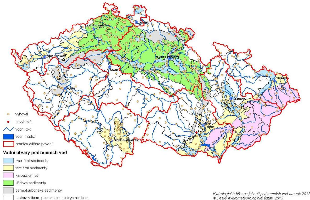
Hodnocení jakosti podzemních vod – porovnání s referenční hodnotou pro podzemní vodu v ukazateli olovo (5 µg/l) dle vyhlášky MŽP a MZe č. 5/2011 Sb. - dílčí povodí Berounky
