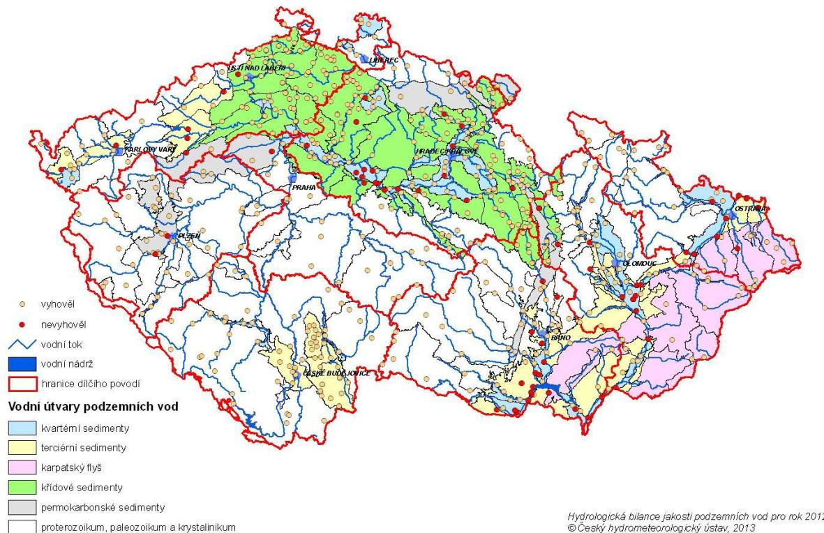
Hodnocení jakosti podzemních vod – porovnání s referenční hodnotou pro podzemní vodu v ukazateli amonné ionty (0.5 mg/l) dle vyhlášky MŽP a MZe č. 5/2011 Sb. - dílčí povodí Berounky
