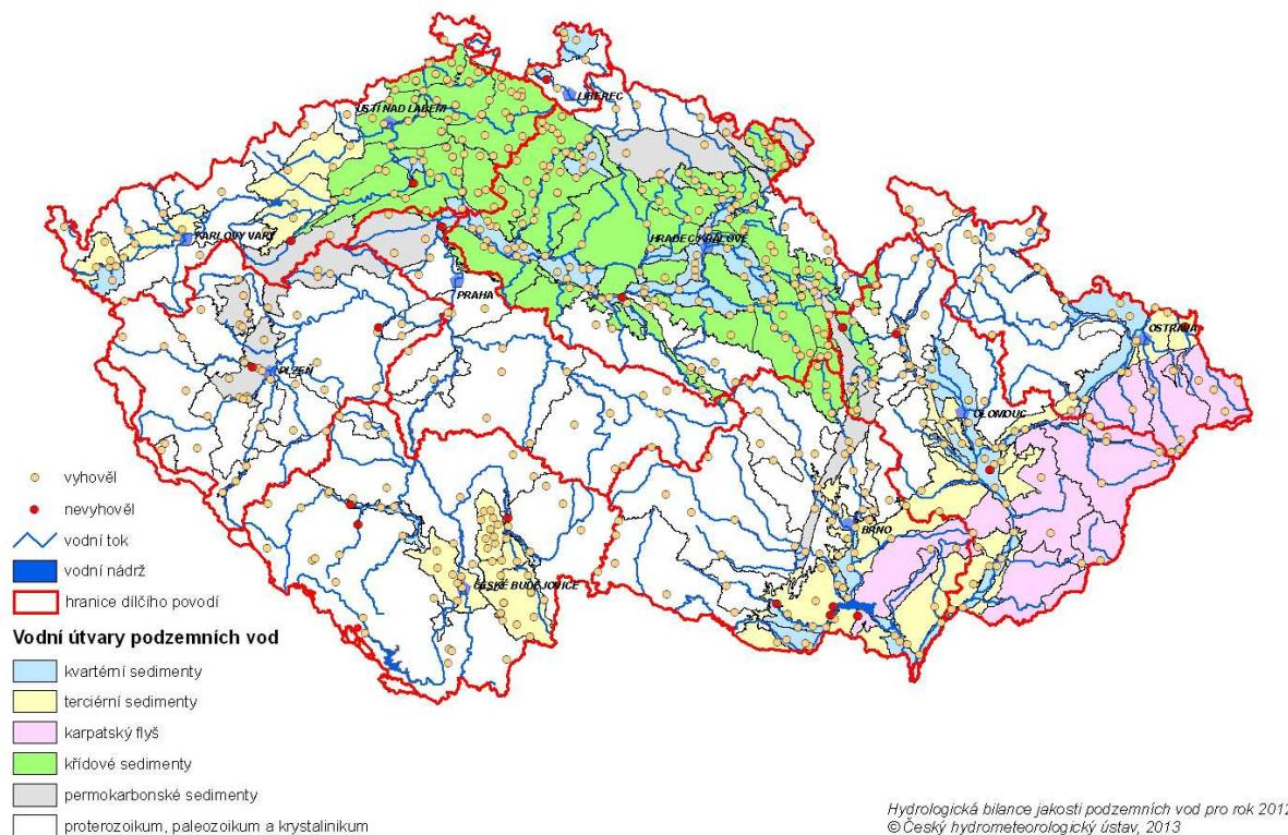
Hodnocení jakosti podzemních vod – porovnání s referenční hodnotou pro podzemní vodu v ukazateli chloridy (200 mg/l) dle vyhlášky MŽP a MZe č. 5/2011 Sb. - dílčí povodí Berounky
