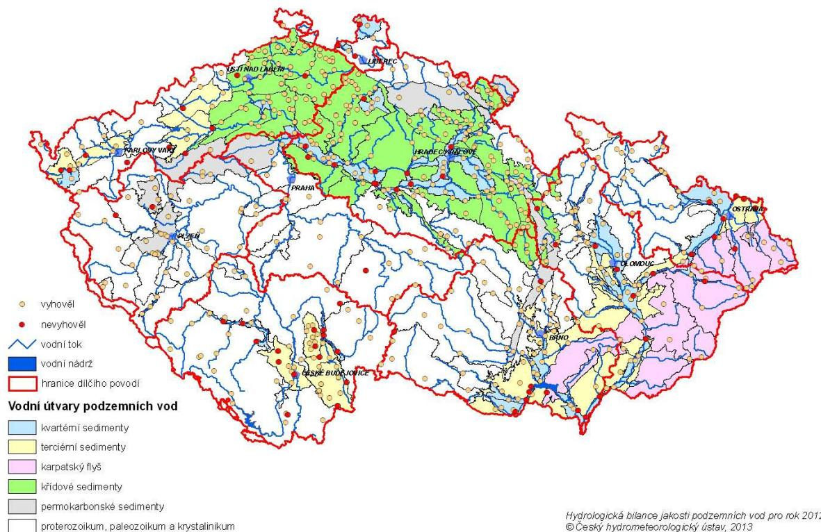
Hodnocení jakosti podzemních vod – porovnání s referenční hodnotou pro podzemní vodu v ukazateli ChSK-Mn (3 mg/l) dle vyhlášky MŽP a MZe č. 5/2011 Sb. - dílčí povodí Berounky
