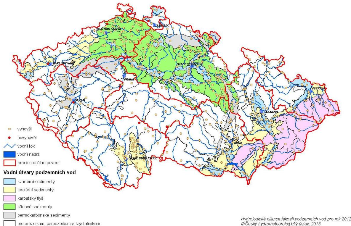
Hodnocení jakosti podzemních vod – porovnání s referenční hodnotou pro podzemní vodu v ukazateli kadmium (0.5 µg/l) dle vyhlášky MŽP a MZe č. 5/2011 Sb. - dílčí povodí Berounky
