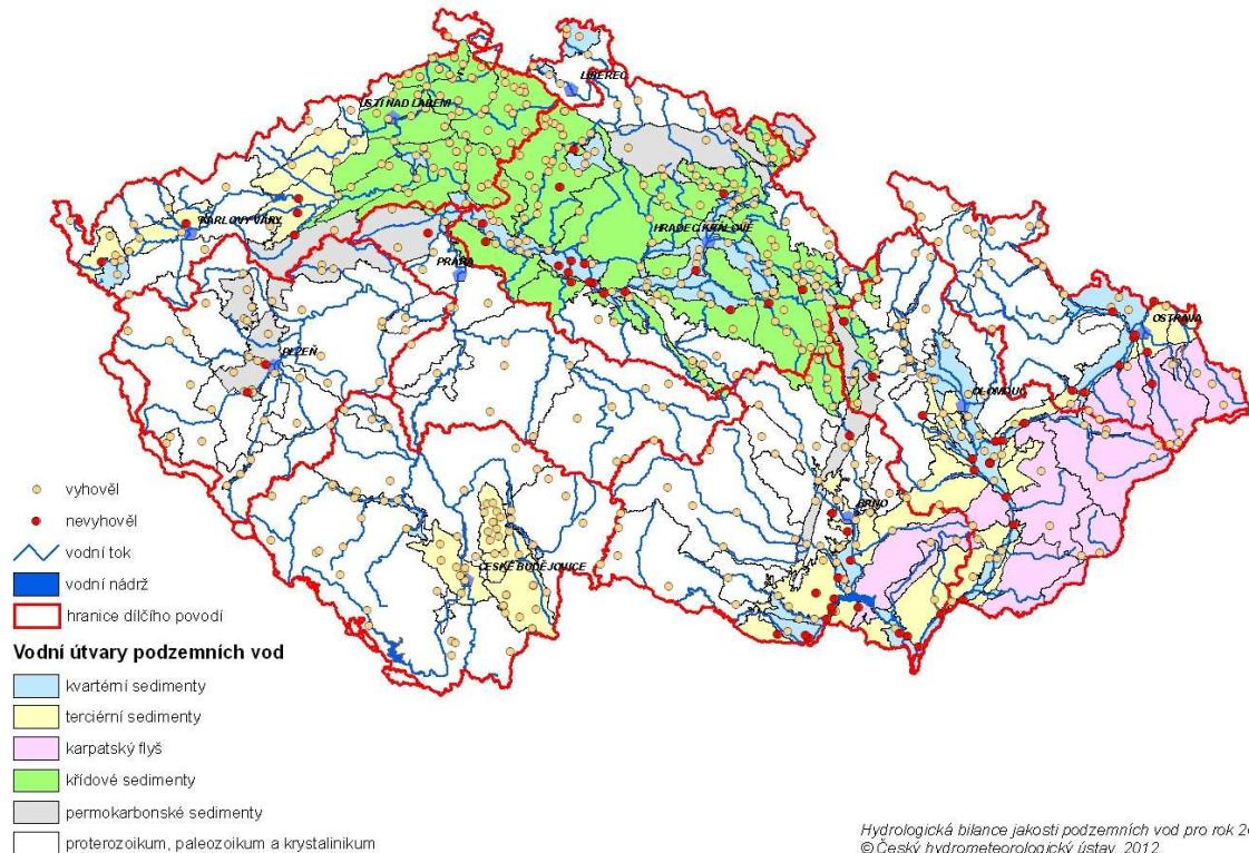
Hodnocení jakosti podzemních vod – porovnání s referenční hodnotou pro podzemní vodu v ukazateli amonné ionty (0.5 mg/l) dle vyhlášky MŽP a MZe č. 5/2011 Sb. - dílčí povodí Berounky
