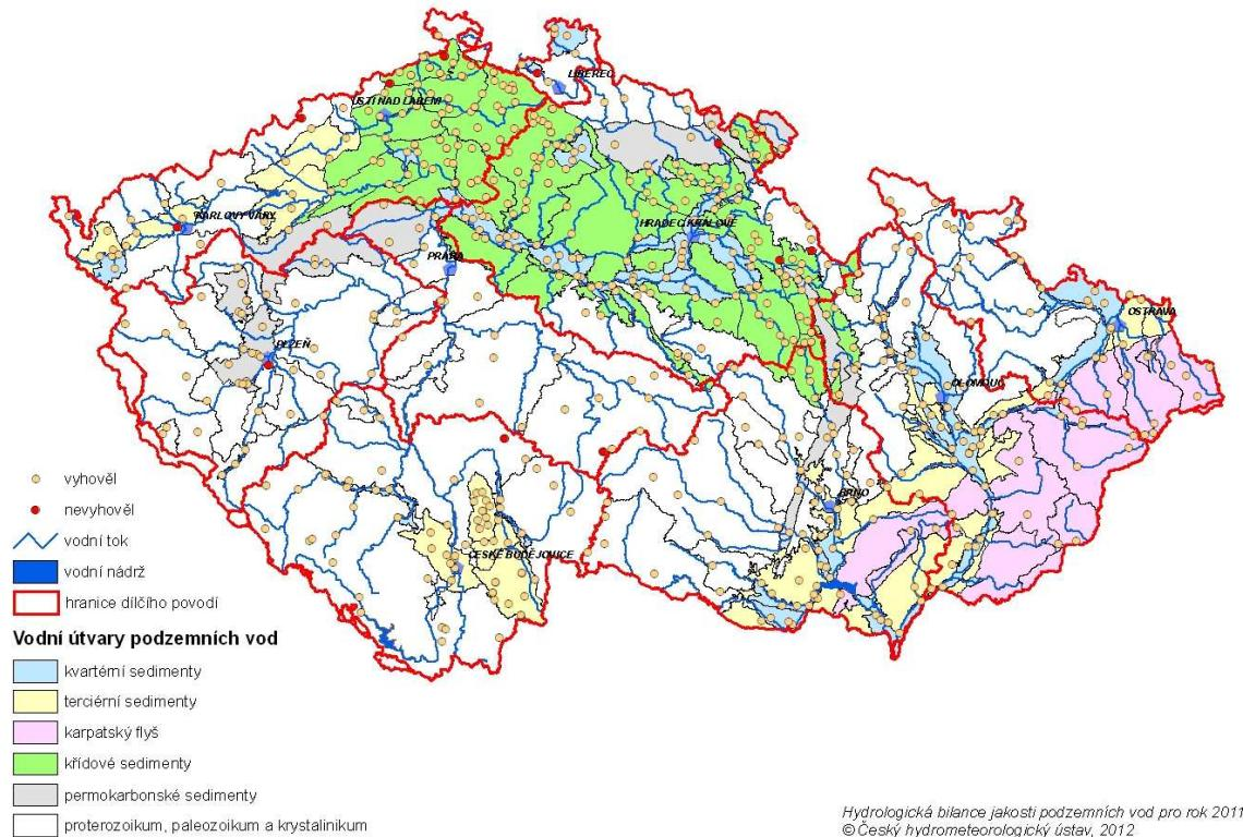
Hodnocení jakosti podzemních vod – porovnání s referenční hodnotou pro podzemní vodu v ukazateli kadmium (0.5 µg/l) dle vyhlášky MŽP a MZe č. 5/2011 Sb. - dílčí povodí Berounky
