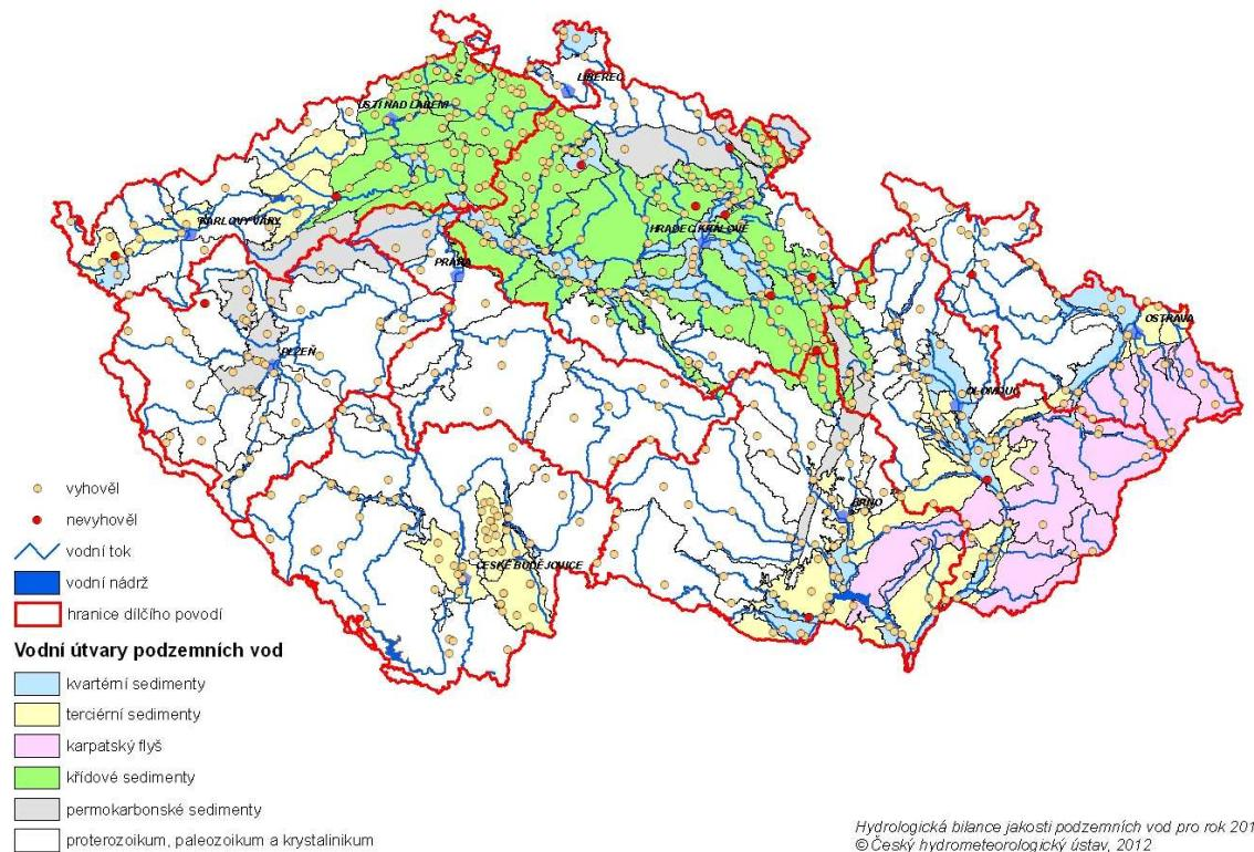
Hodnocení jakosti podzemních vod – porovnání s referenční hodnotou pro podzemní vodu v ukazateli olovo (5 µg/l) dle vyhlášky MŽP a MZe č. 5/2011 Sb. - dílčí povodí Berounky
