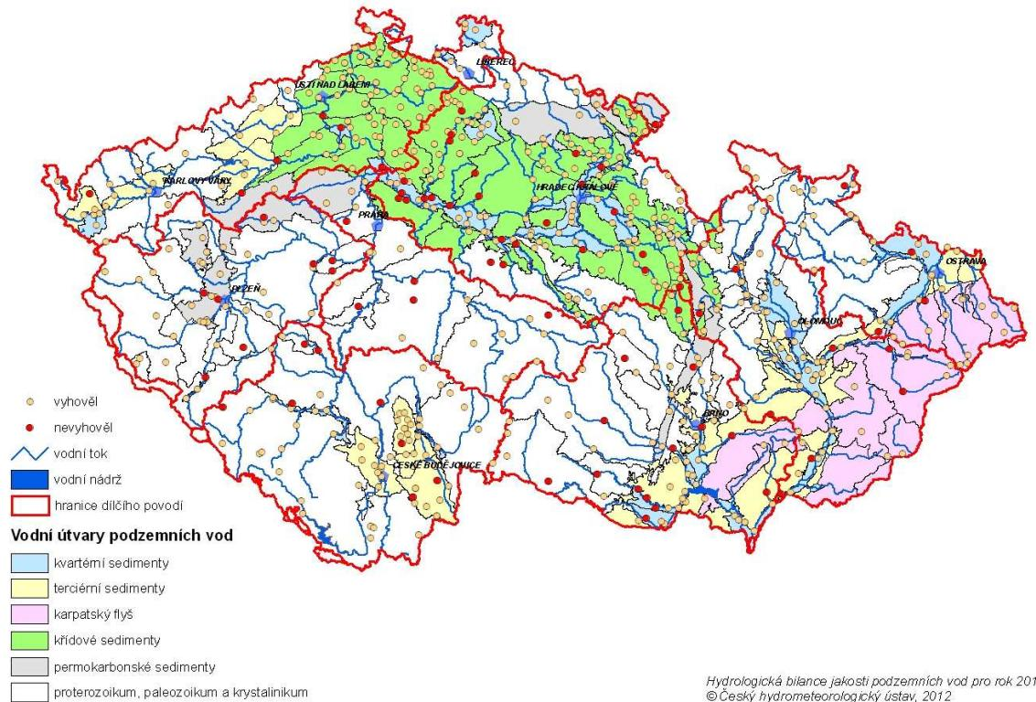
Hodnocení jakosti podzemních vod – porovnání s referenční hodnotou pro podzemní vodu v ukazateli dusičnany (50 mg/l) dle vyhlášky MŽP a MZe č. 5/2011 Sb. - dílčí povodí Berounky
